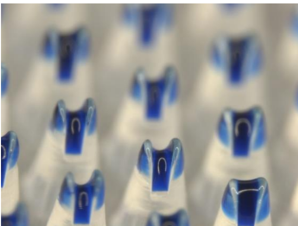
図8 薬剤を塗布した鳥口マイクロニードル(先端)
