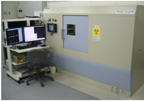
図2 X線CTスキャナの外観
