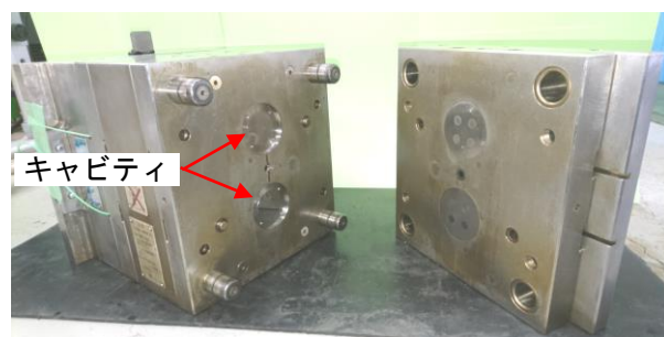
図2 成形品面に直交方向の離型抵抗の計測金型 4)
