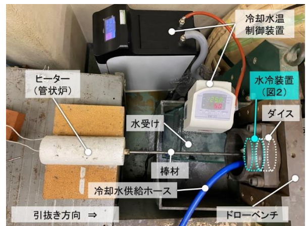
図 11 冷却水温度制御・循環装置外観
