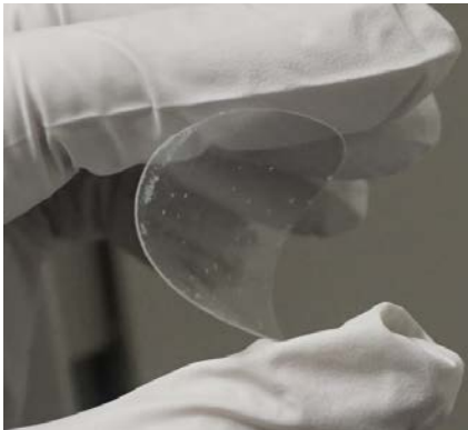
図4 ウェハ形状に圧縮成型した樹脂の写真
