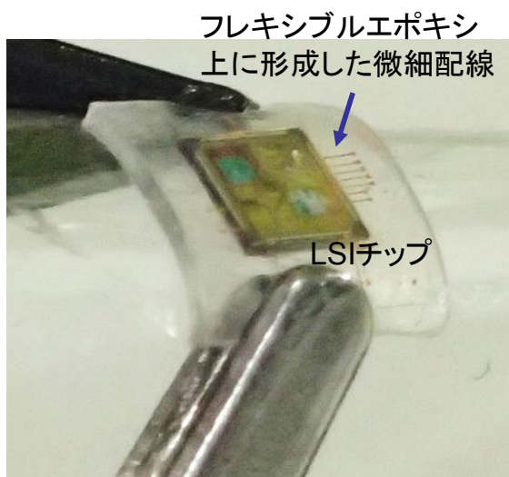
図6 フレキシブルエポキシ/PDMSに圧縮成型で埋め込んだチップの写真
